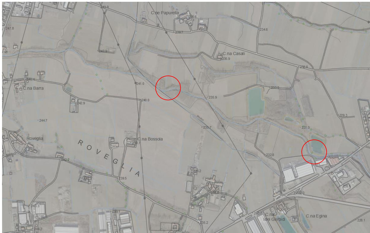
Figura 2 – Linee elettriche aeree di alta tensione poste in prossimità relativa con le opere e gli interventi in progetto. Gli interventi previsti (cerchi rossi) sono a una distanza di minima superiore a 100 m dalla linea elettrica aerea più prossima
